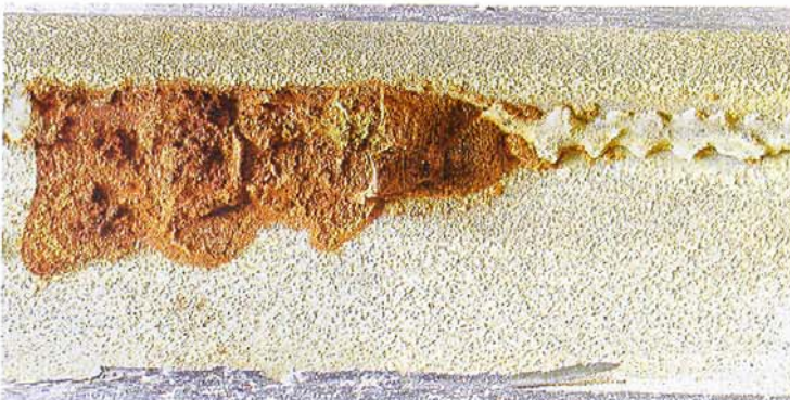
1. ábra. Belső varrat mentén kialakult korrózió
