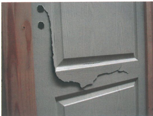
3. fotó – Lágy nehéz test ütésvizsgálat során elszenvedett károsodása. Nem alkalmas a típus közületi, nagy forgalmú irodában való felhasználásra
