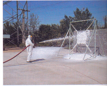
Habbal oltó mobil tűzoltó berendezés MSZ EN 3 szabvány szerinti szigetelés vizsgálata (VEIKI-VNL Kft.)
