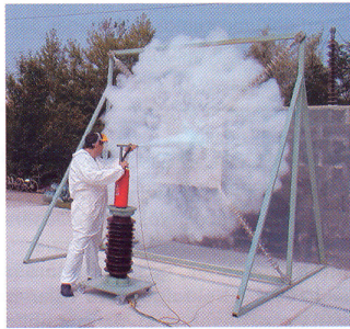
CO2 kézi tűzoltó készülék MSZ EN 3 szabvány szerinti szigetelés vizsgálata (VEIKI-VNL Kft.)
