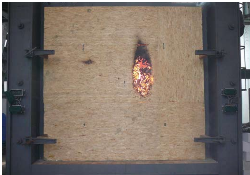
Falszerkezet tűzállósági vizsgálata. Alapvető célkitűzés, hogy tűz esetén az építmény állékonysága biztosítsa a bent lévők biztonságát
