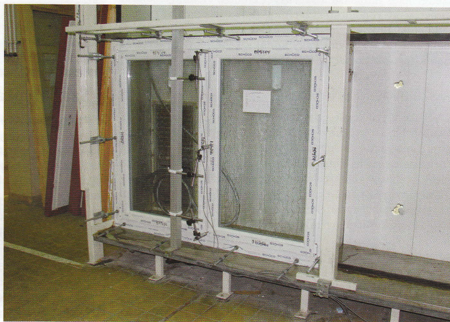
1. kép – A három elmozdulásérzékelő a közepén felnyíló ablak közepén
