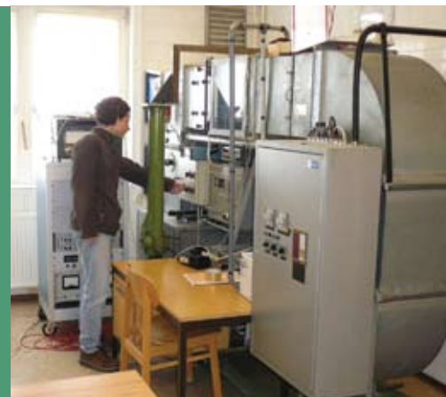
Füstcsatorna vizsgálat füstérzékelők bejelzési küszöbértékének megállapításához
