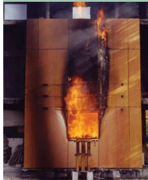
Homlokzati hőszigetelő rendszer tűzterjedési vizsgálata
