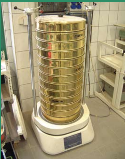
Európai előírásoknak megfelelő szitاسor adalékanyag szemszerkezet vizsgálatához
