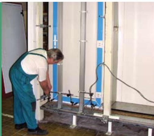
Ajtó szélállóságának vizsgálata
