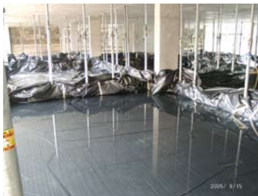
Próbaterhelés vízzel elárasztott medencével
