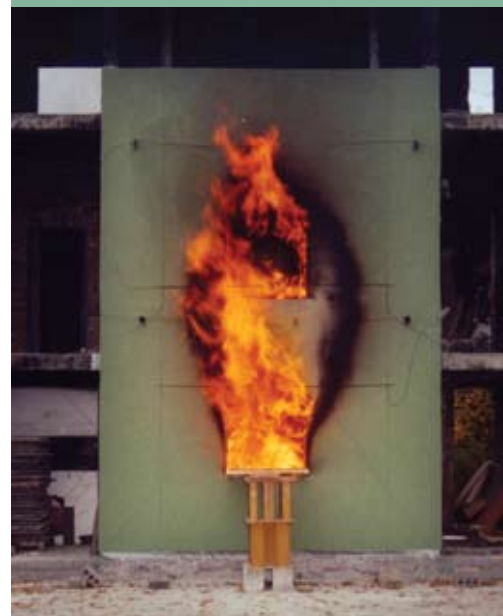
Homlokzatburkolati rendszer tűzterjedési vizsgálata
