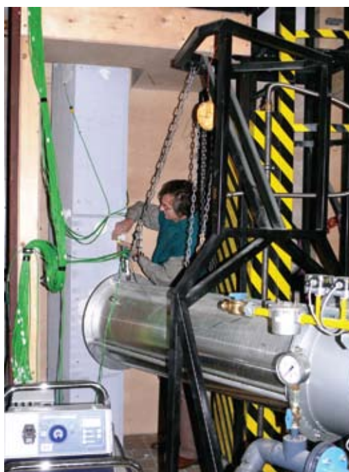
Hőmérséklet-érzékelők felszerelése a kémény külső felületére
