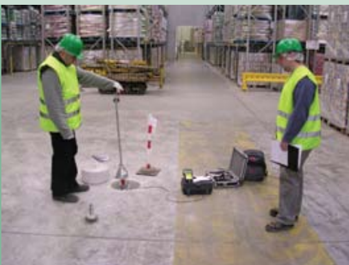
Ipari padló ágyazat teherbírás vizsgálata
