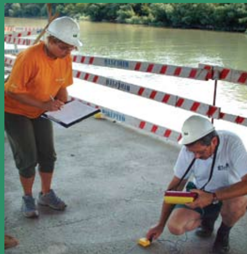
Betontakarás roncsolásmentes vizsgálata
