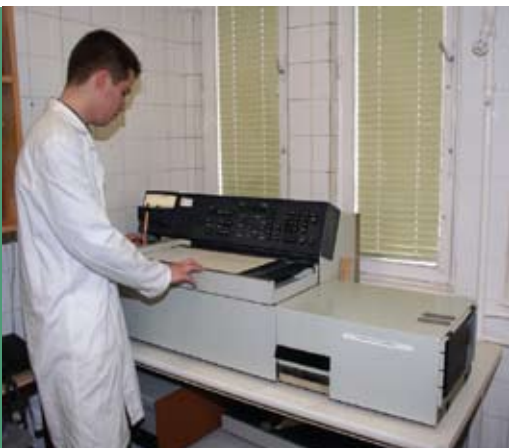
Kémiai ujjlenyomat vétel szerves anyag bázisú termékekről az infravörös tartományban vizsgáló spektroszkópon
