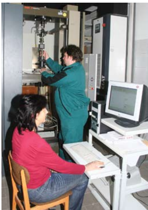
A használati igénybevételekből származó tulajdon-ságváltozások legfontosabb fokmérője a szilárdság alakulása. Korszerű megállapítása és kiértékelése számítógép vezérelt, variálható teher-szituációkkal működő vizsgálóberendezéssel lehetséges.
