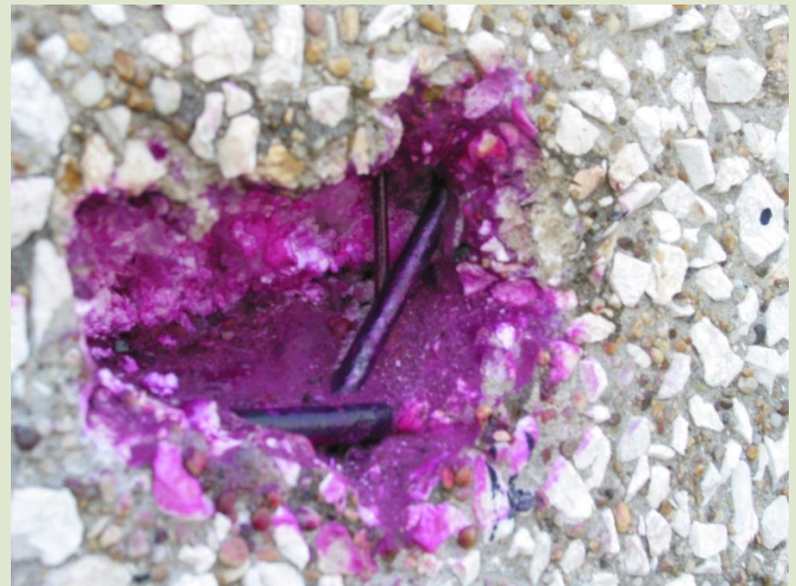
Panelkéreg korróziós vizsgálata roncsolással
